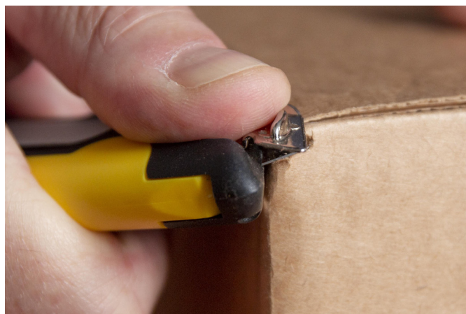
Ровное вскрытие с помощью направляющей
